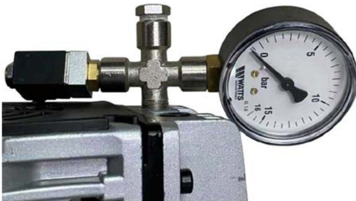
Рис.4 Узел на выходе компрессора в сборе (без трубки напорной линии).
